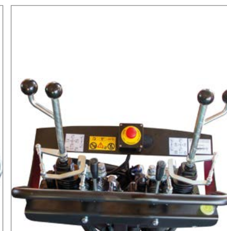
Levier de plateforme tournante, commande à 2 circuits
