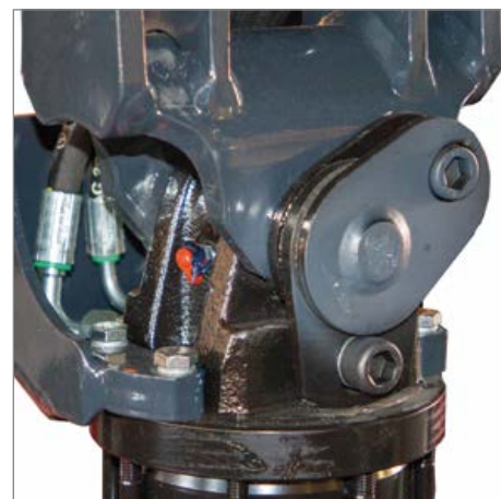
Frein d'oscillation à simple effet
