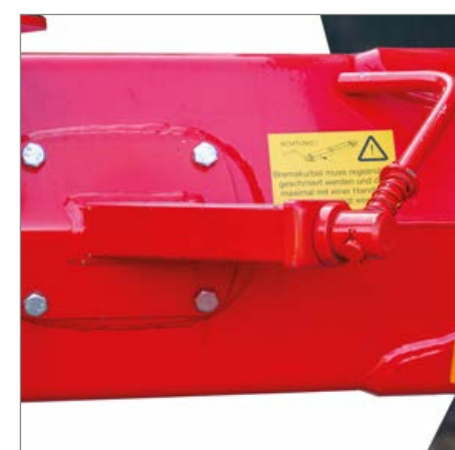
Frein de stationnement avec système de frein hydraulique 25 km/h
