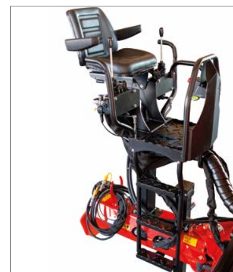
Siège de timon commande à 2 circuits
