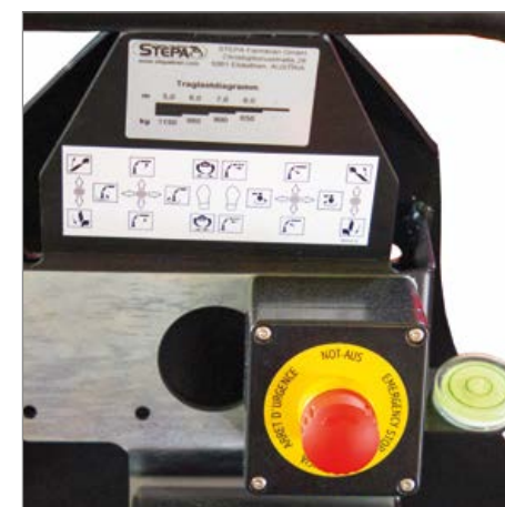
Dispositif d'arrêt d'urgence toujours à portée de main
