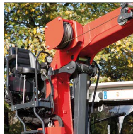
Treuil de traction (en option) Câble de 7 mm d'épaisseur et de 40 m de longueur avec une force de traction de 1,5 t
