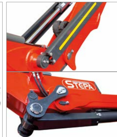
Hub- & Knickzylinderschutz bei Z- und L-Kran
