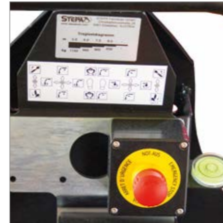
NOT-HALT Einrichtung immer in Griffweite
