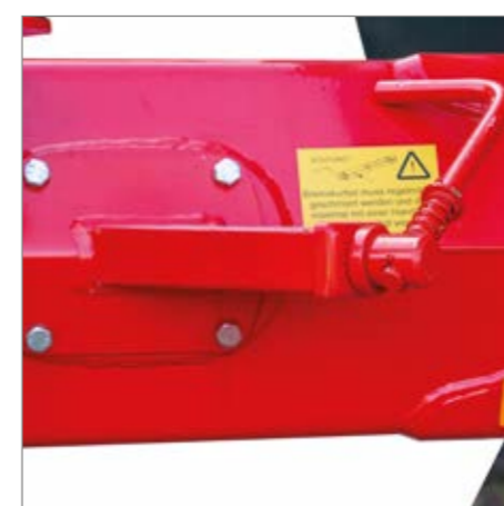
Feststellbremse bei hydr. Bremsanlage 25 km/h
