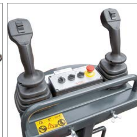
Joystick hydr./elektr. 2-Kreis Steuerung
