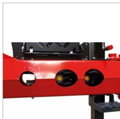
Pumpe in der Deichsel geschützt verbaut
