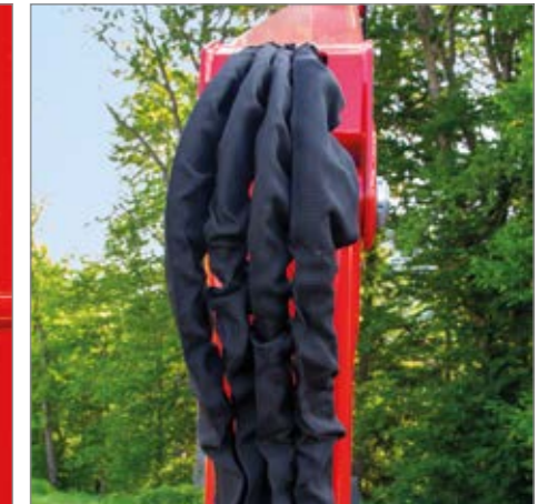
Geschützte und abgedeckte Schlauchführung
