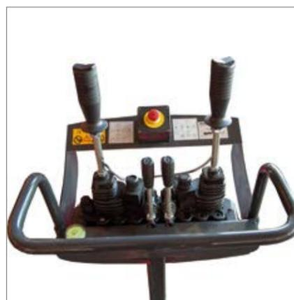
Commande standard ON-OFF ou à 1 ou 2 circuits
