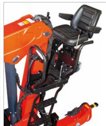
Siège sur colonne commande à 2 circuits
