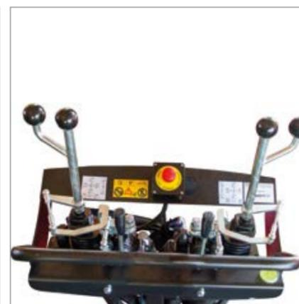
Levier de plateforme tournante, commande à 2 circuits
