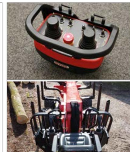
Radio-télécommande Joystick Siège sur colonne
