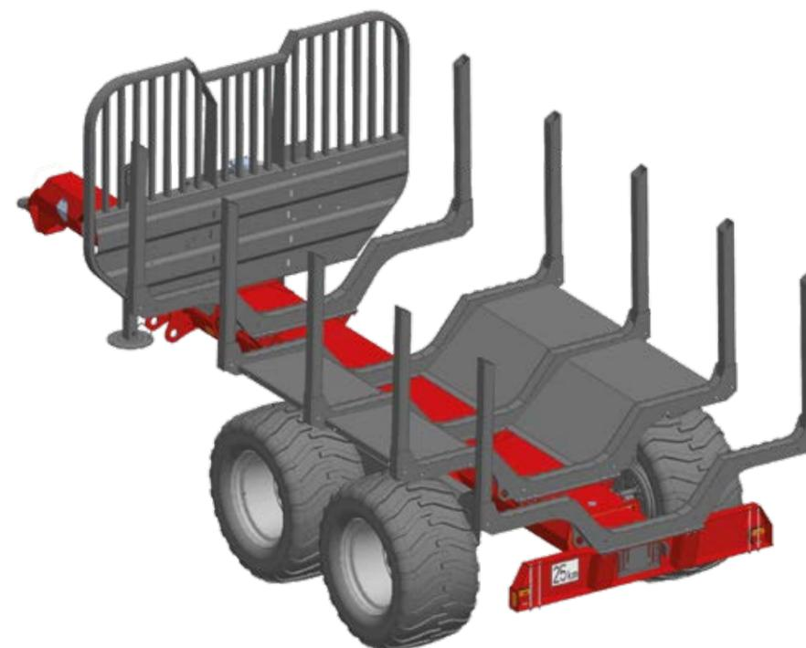
**Protection des roues avec bac de plancher court 2 ou 4 pièces**
