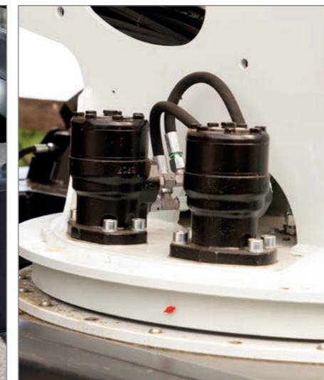
zwei Schwenkmotore optional mit Bremse
