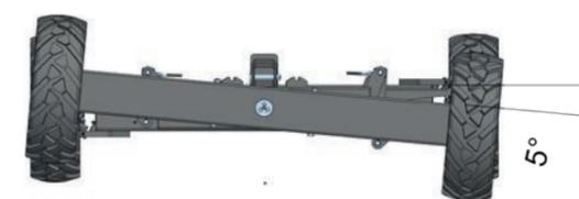
L'essieu oscillant assure le contact de toutes les quatre roues avec le sol. Lors du fonctionnement de la grue, l'essieu oscillant est automatiquement bloqué hydrauliquement.
